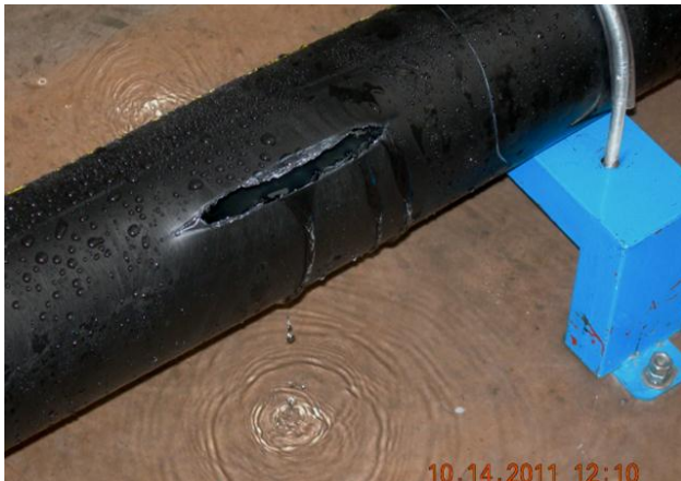
Foto 2: Tubo fallado por repetición de sobrepresión extrema, Prueba 3a.
