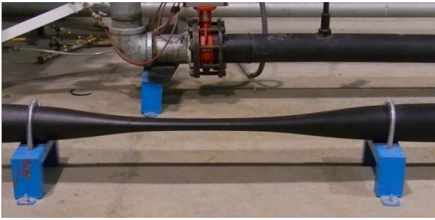
Foto 4: Deformación de la tubería RD 41 durante la primera depresión, Prueba 4.
