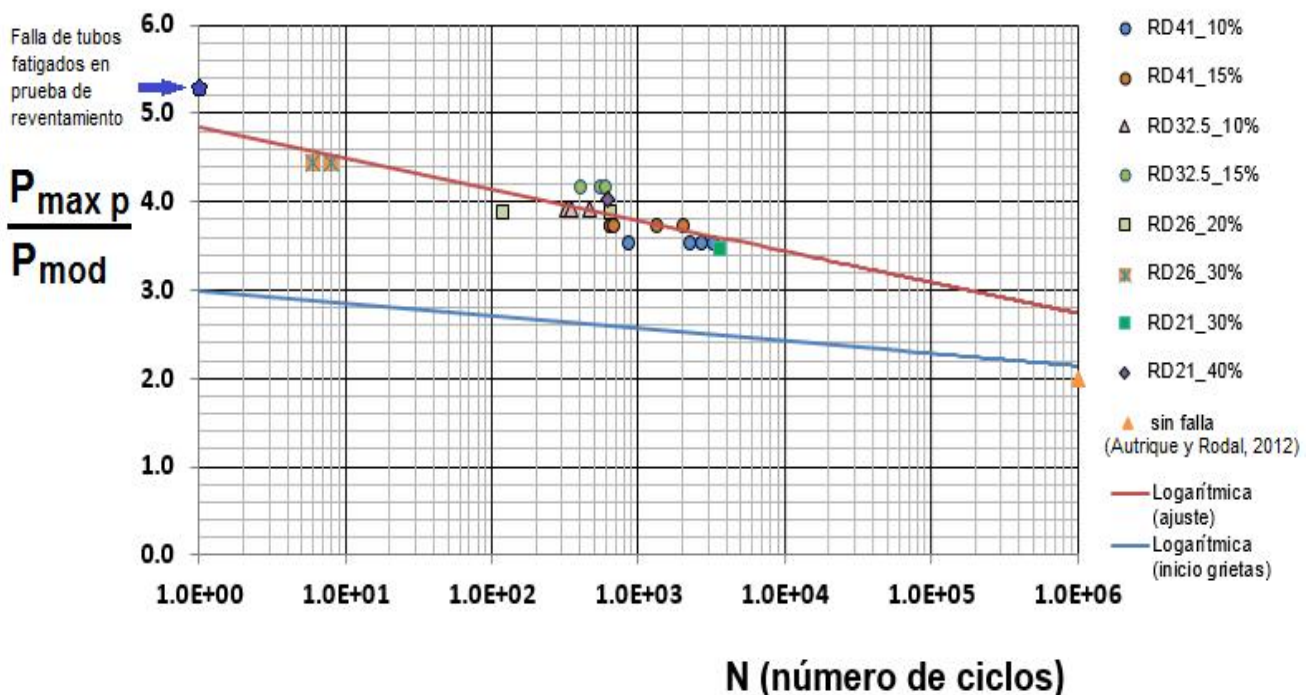
Figura 9. Resultados experimentales de las pruebas de fatiga y curva S-N ajustada logarítmicamente.
